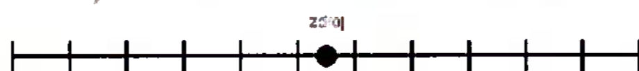
Obr. 10. Vodiče, obsahující zdroje a zátěže, je v NEC vhodné dělit na lichý počet segmentů
