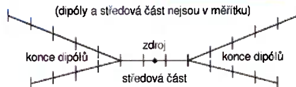
Obr. 12. Spojení částí antény pomocí vložené krátké společné sekce s napájecím bodem
